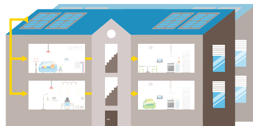
Plusieurs consommateurs profitant de l'énergie produite par une même installation solaire.
